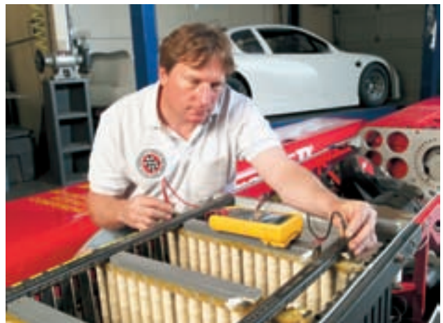
赛车团队经理Gus F owlie正在对“白色闪电”使用的电池组进行电压测试，该电池组由多块C型镍氢电池组成。
