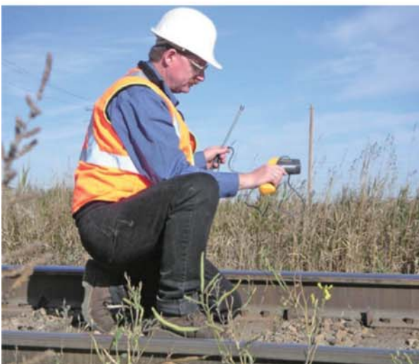
在钢轨测试之后，查看红外测温仪读数。
